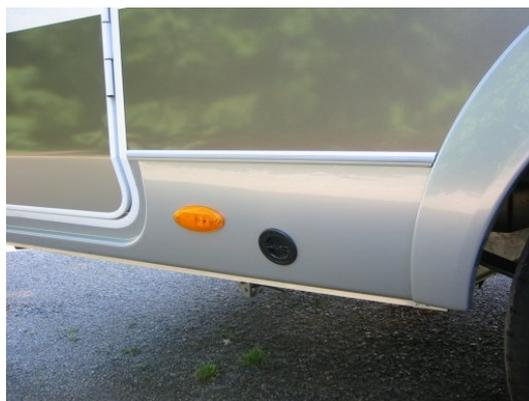
La coupelle de remplissage est fixée dans le bas de caisse pour ne pas percer la paroi.
