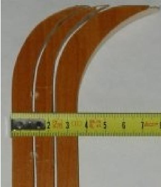
Les morceaux supprimés à la scie sauteuse, représente une épaisseur totale de 35mm.
