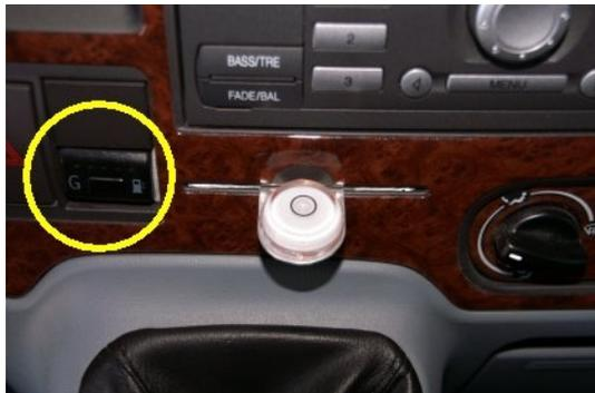
L'interrupteur de commande de la vanne est installé sur le tableau de bord, dans un des emplacements libres.
