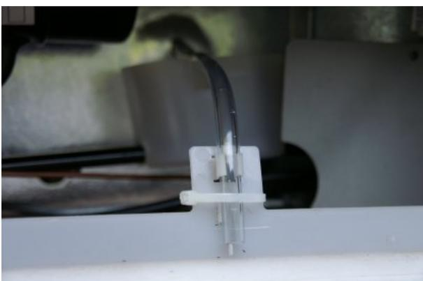
**La fixation du tuyau à l'avant :** parce que j'en avais un sous la main, j'assure le maintien du tube avec un collier rylsan.
